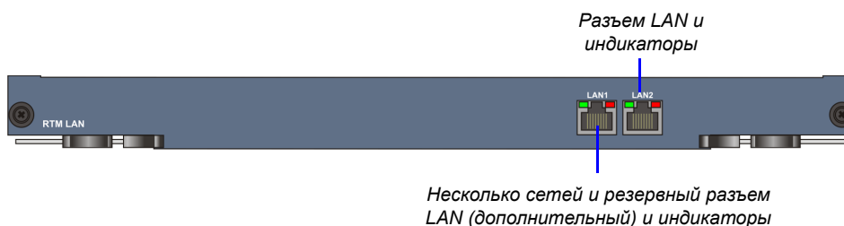
Рис. 1-4 RMX 2000 Компоновка задней панели платы RTM LAN
